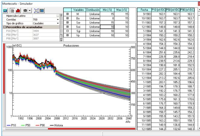
**Ventana de simulación de Montecarlo.** Se observa el resultado de una simulación con 1000 corridas para una simulación realizada con Flujo Segregado en la que se realizó una sensibilidad con el parámetro Movilidad.
